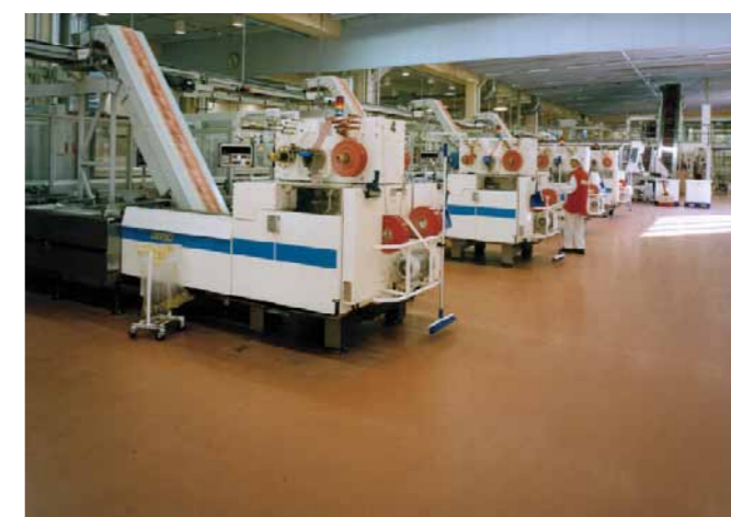
En polyuretanbaseret gulvbelægning til overflader som kræver høj kemikalieresistens og som udsættes for varmt vand og damprensning.
